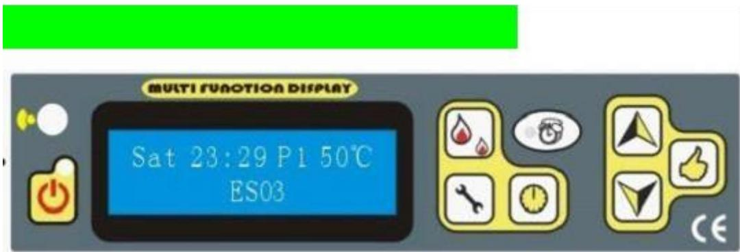
ES03 – senzor sobne temperature nema napona, struje
