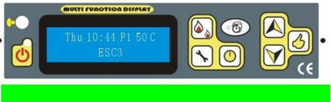
ESC3 – senzor sobne temperature ( koji je na stražnjoj donjoj strani peći) je u kratkom spoju
