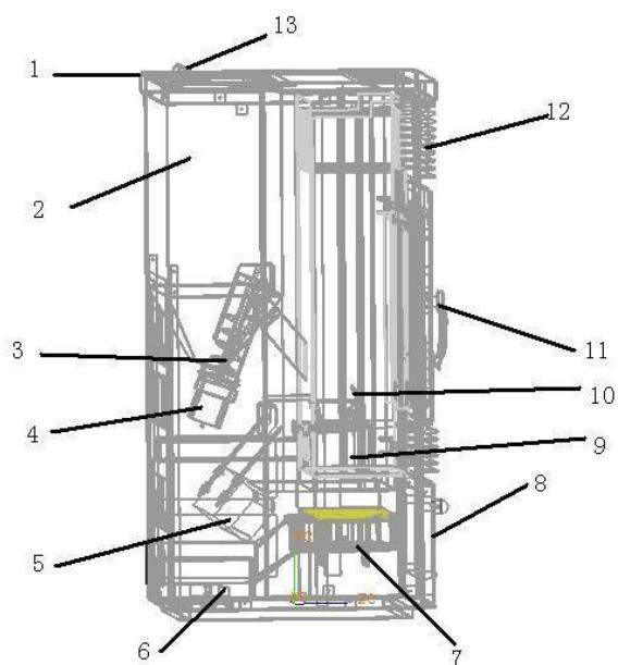
1. Kućište spremnika 2.Spremnik 3.Puž za ubacivanje peleta u ložište 4.Motor puža
