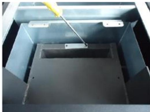
Čišćenje svih odvoda i dovoda zraka/plinova se mora očistiti minimalno jednom godišnje tako da se odstrane bočne strane peći, sa usisavačem i četkom očiste svi dijelovi. Obratiti pažnju na lomljive dijelove i na žice koje su unutar peći – da ne dođe do oštećenja.
